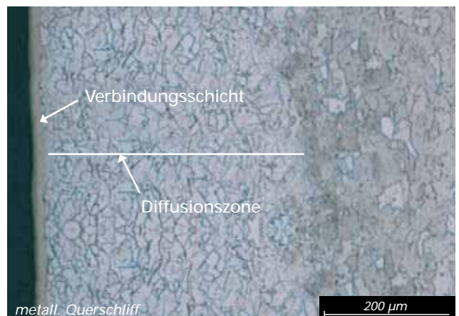
Gefügedarstellung einer plasmanitrierten Randschicht.
